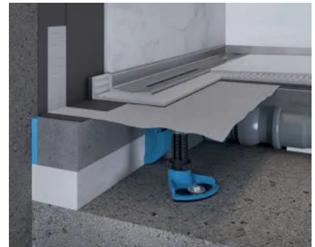
Einbaubeispiel DallFlex 2.0 mit CeraWall Pure
