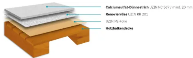
UZIN Dünnestrich auf Trennlage, Untergrund Holzbalkendecke
