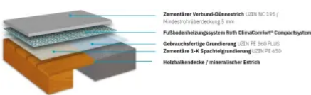
Zementärer Verbund-Dünnestrich UZIN NC 195 mit Fußbodenheizung
