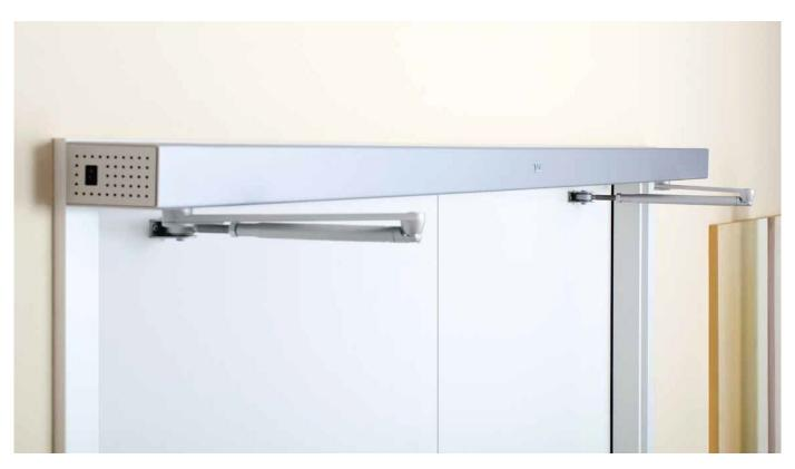
Elektromechanische und elektrohydraulische Drehflügeltürantriebe mit selbstlernender Mikroprozessorsteuerung für 1- und 2- flügelige Drehflügeltüren. Verschiedene Ausführungsvarianten wie zum Beispiel Antriebe mit Vollautomatik, Antriebe für Feuer- und Rauchschutztüren sowie Antriebe für Innentüren, die Menschen mit Handicap bei der Nutzung von Türen unterstützen.
