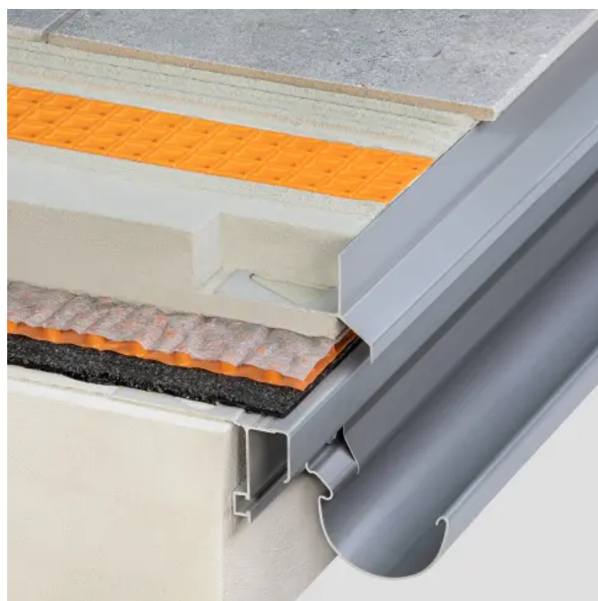
Balkonkonstruktion mit Schlüter®-TROBA-PLUS Flächendränage. Das BARA-RTK Profil deckt die Estrichschicht sauber ab und fungiert als Tropfkante. Das BARA-RTK trägt das Rinnensystem.
