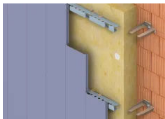
Hinterlüftete Fassade – senkrecht auf Mauerwerk mit Dämmung
