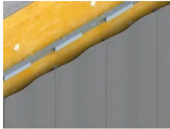
Hinterlüftete Fassade – senkrecht auf Betonwand mit Dämmung
