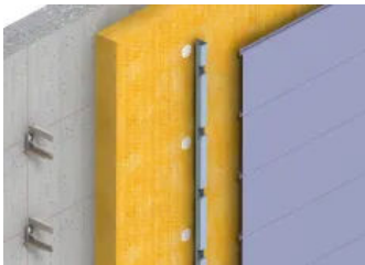
Hinterlüftete Fassade – waagrecht auf Betonwand mit Dämmung
