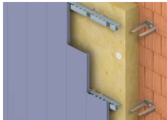
Hinterlüftete Fassade – senkrecht auf Mauerwerk mit Dämmung
