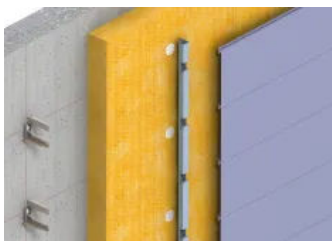
Hinterlüftete Fassade – waagrecht auf Betonwand mit Dämmung
