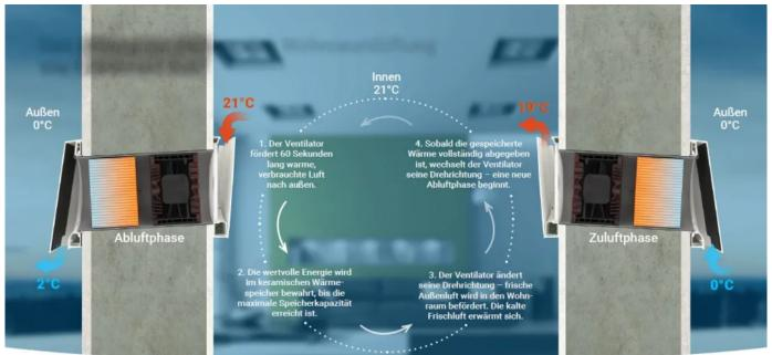
Das Prinzip der Wärmerückgewinnung
