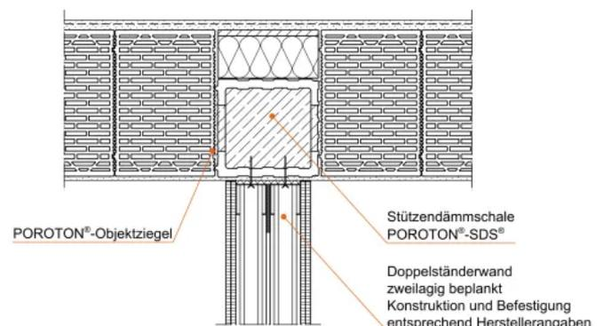
Außen-/Innenwandanschluss mit Stütze: Leichte Trockenbau-Trennwand an Stützendämmschalung POROTON®-SDS® in Außenwand
