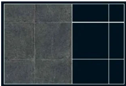
Gerade Verlegung Fliesen
