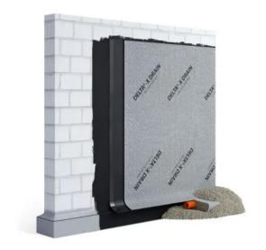
Das einzigartige vierlagige Schutz- und Dränsystem für Einbautiefen bis 10 m. Mit integriertem Selbstkleberand und mikroperforierter Schutz- und Gleitschicht.
