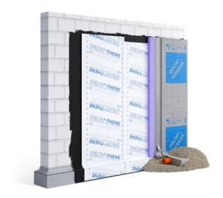
Vollflächig kaltselbstklebende Bahn (KSK) zur Abdichtung erdberührter Bauteile gegen Bodenfeuchte und nichtdrückendes Wasser. Auch als Zuschnitt in 10, 15, 30 und 50 cm Breite erhältlich: Für die Detailausbildung, z. B. an Kanten, Ecken, Hohlkehlen und Rohrdurchführungen. Mit geteiltem rückseitigen Trennpapier.
