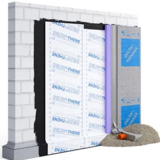
Vollflächig kaltselbstklebende Bahn (KSK) zur Abdichtung erdberührter Bauteile gegen Bodenfeuchte und nichtdrückendes Wasser. Auch als Zuschnitt in 10, 15, 30 und 50 cm Breite erhältlich: Für die Detailausbildung, z. B. an Kanten, Ecken, Hohlkehlen und Rohrdurchführungen. Mit geteiltem rückseitigen Trennpapier.
