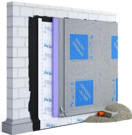
Universelles Schutz- und Dränsystem für begrünte sowie begeh- und befahrbare Flächen und für vertikale Anwendungen bei Einbautiefen bis 10 m. Auf einer Längsseite ca. 10 cm breiter glatter Überlappungsrand mit Selbstklebezone. Das Geotextil steht entsprechend über. Alkalien- und chemikalienbeständig, unverrottbar im Erdreich.
