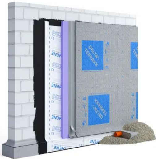
Universelles Schutz- und Dränsystem für begrünte sowie begeh- und befahrbare Flächen und für vertikale Anwendungen bei Einbautiefen bis 10 m. Auf einer Längsseite ca. 10 cm breiter glatter Überlappungsrand mit Selbstklebezone. Das Geotextil steht entsprechend über. Alkalien- und chemikalienbeständig, unverrottbar im Erdreich.
