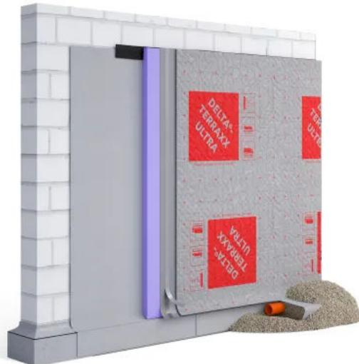
Universelles Schutz- und Dränsystem für begrünte sowie begeh- und befahrbare Flächen und für vertikale Anwendungen bei Einbautiefen bis 20 m. Auf einer Längsseite ca. 10 cm breiter glatter Überlappungsrand mit Selbstklebezone. Das Geotextil steht entsprechend über. Alkalien- und chemikalienbeständig, unverrottbar im Erdreich.
