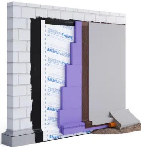
Noppenbahn mit hoher Druckfestigkeit für den Einsatz als Anfüllschutz, als Sauberkeitsschicht und als Sickerschicht in zweischaligen Konstruktionen (z. B. Verbau).
