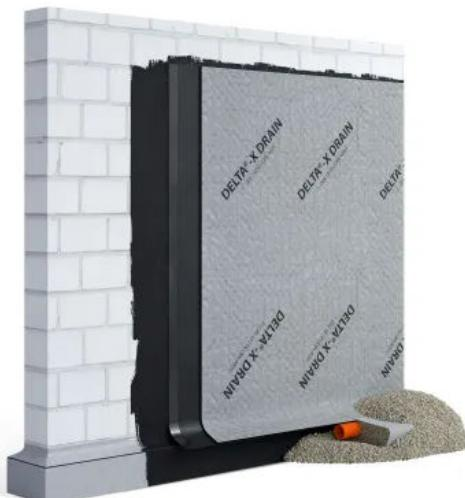
Das einzigartige vierlagige Schutz- und Dränsystem für Einbautiefen bis 10 m. Mit integriertem Selbstkleberand und mikroperforierter Schutz- und Gleitschicht.
