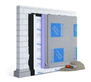
Universelles Schutz- und Dränsystem für begrünte sowie begeh- und befahrbare Flächen und für vertikale Anwendungen bei Einbautiefen bis 10 m. Auf einer Längsseite ca. 10 cm breiter glatter Überlappungsrand mit Selbstklebezone. Das Geotextil steht entsprechend über. Alkalien- und chemikalienbeständig, unverrottbar im Erdreich.
