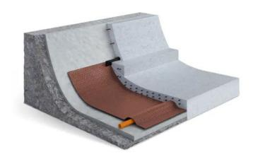
20 mm hohe Noppenbahn mit hoher Dränagekapazität für den horizontalen odervertikalen Einsatz in 2-schaligen Konstruktionen. Noppen in Oktagon-Form mit Verstärkungsrippen sorgen für eine besonders hohe Druckfestigkeit.
