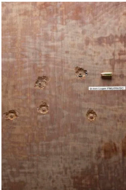
Panzerholz Protect Platte nach Beschuss
