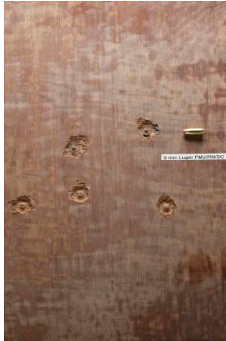
Panzerholz Protect Platte nach Beschuss
