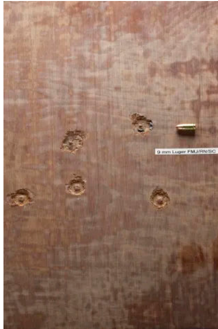
Panzerholz Protect Platte nach Beschuss
