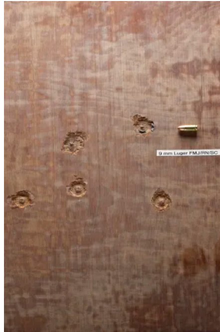
Panzerholz Protect Platte nach Beschuss
