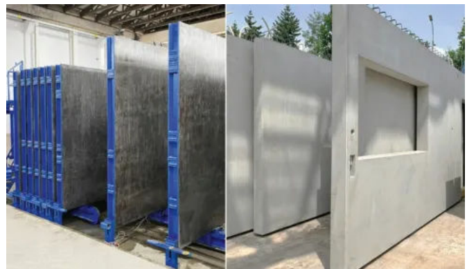
Beidseitig schalplatte Stahlbetonwände, Wanddicke d= 20 | 18 | 12 cm
