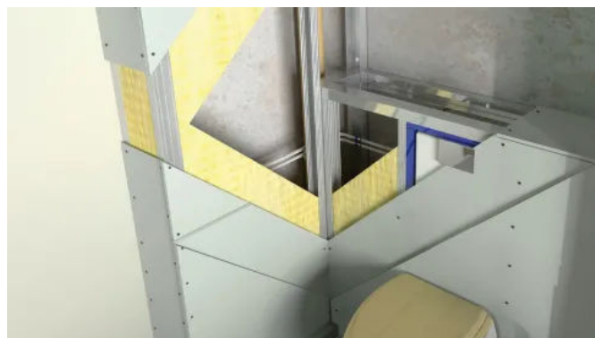
Vorwandkonstruktionen vermeiden Stemmarbeiten bei Nachinstallationen.
