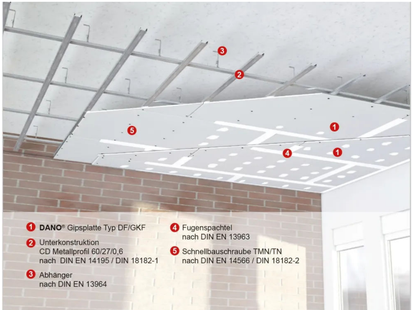
D 30-50 Unterdeckenbekleidung F30-A (2 x 12,5 mm DANO® Feuer DF/GKF)
