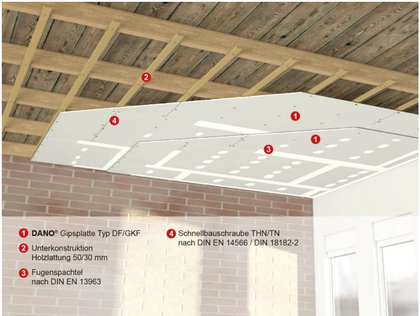
D 60-51 Unterdeckenbekleidung F60-B (15 + 18 mm Dano® Feuer DF/GKF)
