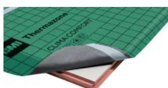
Hocheffizientes, diffusionsfähiges Dämmelement für den Einsatz in der Dachsanierung und im Neubau zur optimalen Dämmung des Daches. Die Verlegung erfolgt als vollflächige Dämmung oberhalb der Sparren, verhindert dadurch Wärmebrücken und kann ohne Schalung verlegt werden.
