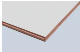
Hocheffizientes, diffusionsfähiges Dämmelement aus Resol-Hartschaum ohne aufkaschierte Unterdeckbahn zur effizienten Dämmung des Daches im Neubau und bei energetischer Modernisierung. Empfohlener Einsatz beispielsweise Schalungssatz mit Divoroll Top RU oder Divoroll Premium WU als Unterdach, auch für das Braas 7GRAD Dach.
