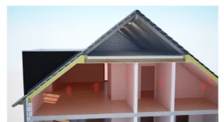
Heizwärmeverlust über ein ungedämmtes Dach
