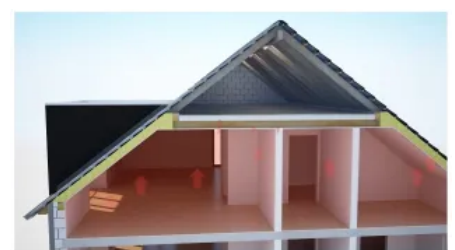
Heizwärmeverlust über ein ungedämmtes Dach
