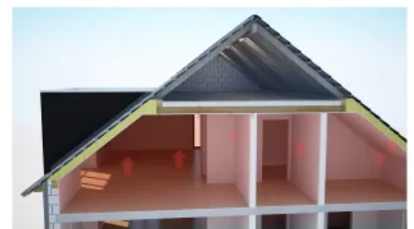
Heizwärmeverlust über ein ungedämmtes Dach
