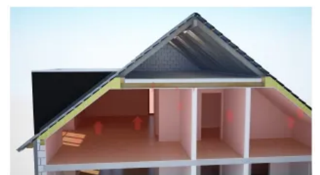
Heizwärmeverlust über ein ungedämmtes Dach
