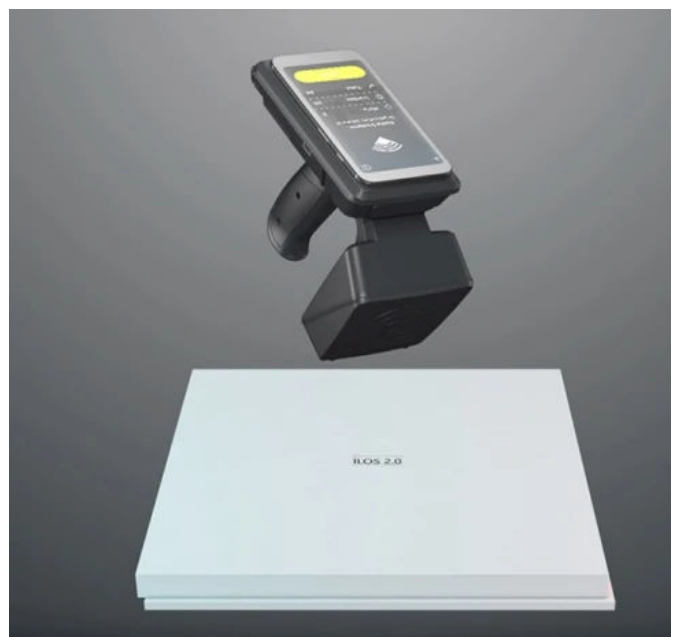
ILOS 2.0 Flachdachdämmplatte mit Sensor und Handschanner
