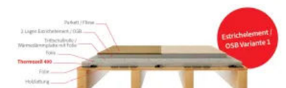
Thermozell mit Trockenestrich auf Holzbalkendecke
