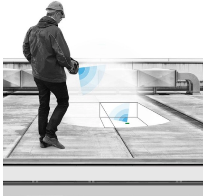
Mittels Handschanner und Smartphone kann die Funktionsfähigkeit der Dachabdichtung permanent überwacht werden.
