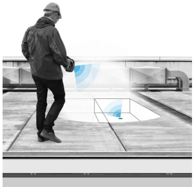
Mittels Handscanner und Smartphone kann die Funktionsfähigkeit der Dachabdichtung permanent überwacht werden.
