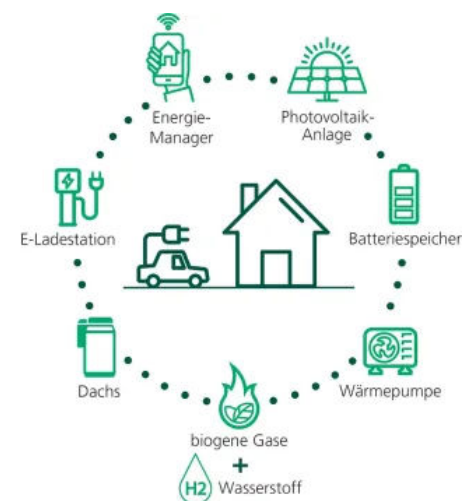
Beispiel Systemlösung im Mehrfamilienhaus: Der Dachs mit PV, Ladestation am Stellplatz, Stromspeicher, Energiemanager
