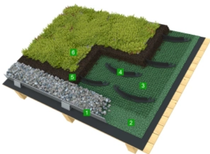
Aufbau Schrägdach 15°-45° System N – © Optigrün
