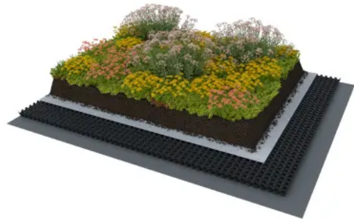
Naturdach Lösung mit Festkörperdränage © Optigrün
