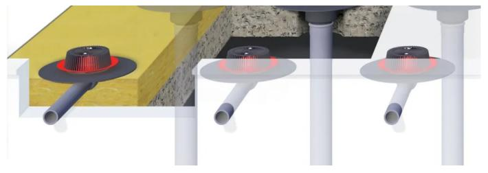
Laut DIN 1986 - 100 muss jedes Flachdach gegen das "Fünfminutenregenereignis einmal in 100 Jahren" abgesichert werden. Dallmer Notabläufe (Dachablauf mit Anstauring) entwässern das Flachdach dort, wo das Wasser anfällt. Und das mit erheblich besseren Ablaufleistungen als einfache Attikaabläufe aufweisen.
