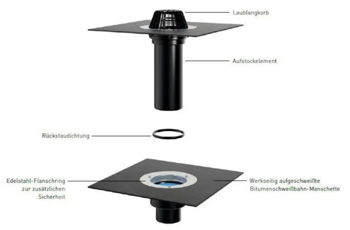
Mit den Dachabläufen 62 mit senkrechtem Abgang in den Nennweiten von DN 70 bis DN 150 sowie die Dachabläufe 64 mit seitlichem Kombi-Abgang DN 70 / DN 100 können die meisten Anforderungen abgedeckt werden. Die Ablaufleistungen dieser Serien liegen über den Normenanforderungen. Optional können diese Dachabläufe auch mit einer selbstregelnden Wärmequelle (230 V) geliefert werden.
