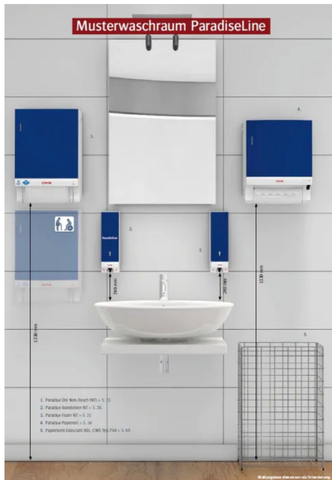
Musterwaschraum ParadiseLine mit optimaler Ausstattung und vorgeschlagenen Montagemaßen. (komplette Darstellung als PDF)
