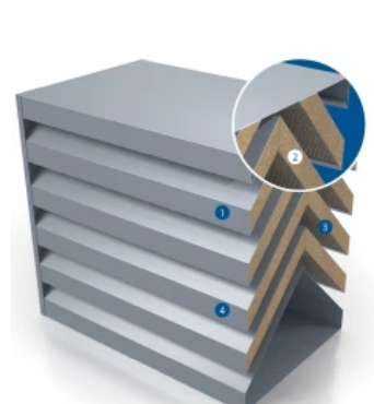
Schallschutzgitter A-600C | 600 mm tiefe Doppelbanklamellen mit horizontaler Chevron-Blatt-Anordnung Schallreduzierung von 19 dB
