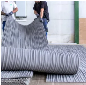
Strukturmatrizen sind flexible Formen
