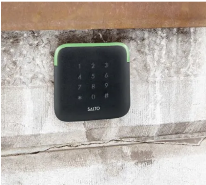
Das wetterfeste Gehäuse schützt die Elektronik (Schutzklasse IP66) für den Außeneinsatz.
