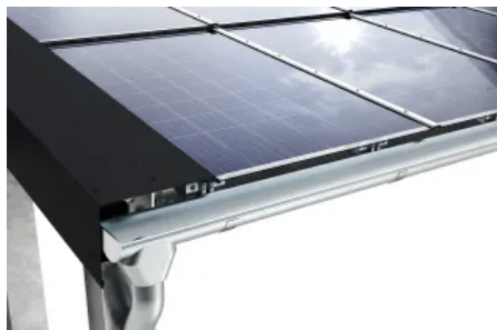
Die Pultdachfläche besteht aus 15 Glas-Glas-Photovoltaik-Modulen mit 5 mm Stärke.
