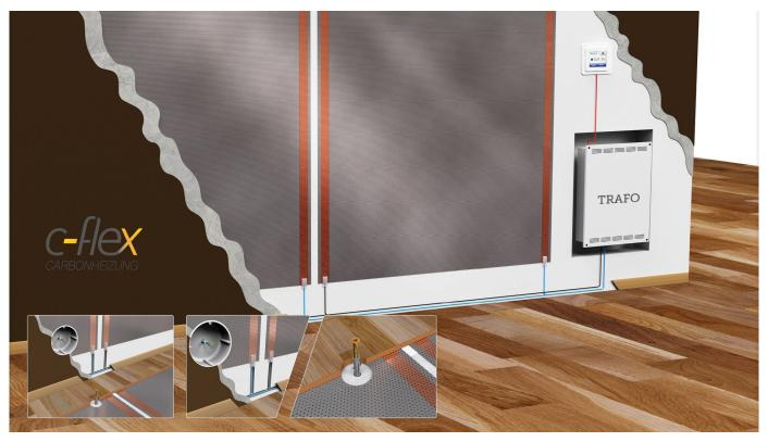
Bei der c-flex – Carbon-Flächenheizung der MHG CARBONlinie wird Wärmestrahlung durch schwachen Strom erzeugt und in leitfähige Carbon-Heizfilme eingeleitet. Die flexibel in Decke, Wand- oder Fußboden eingelegten Filme geben die Wärmestrahlung großflächig und gleichmäßig in den Raum ab.
