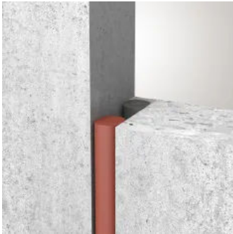
ZZ® G50 Brandschutzfugendichtung - einseitig ohne Silikon
