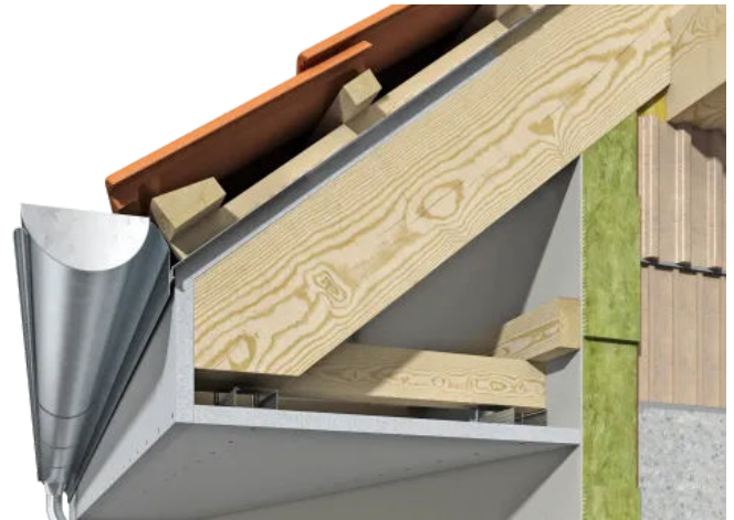
Bekleidung von Dachüberständen zum Schutz vor Brandüberschlag
