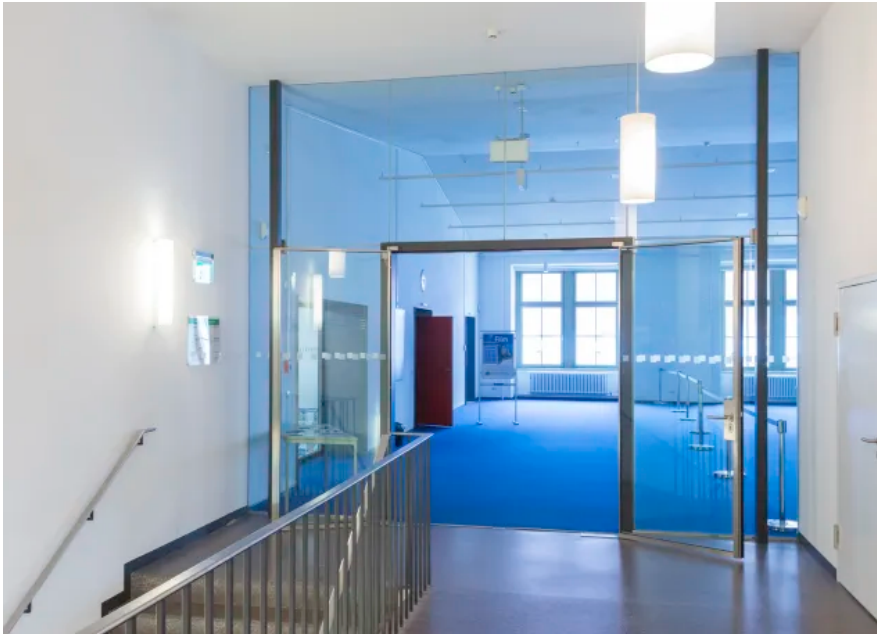
Sächsisches Verkehrsmuseum | Im Zuge der Sanierung wurde auf größtmögliche Transparenz geachtet und moderne Brandschutzverglasungen ohne allgemeine bauaufsichtliche Zulassung integriert. (© Thomas Moeller)
