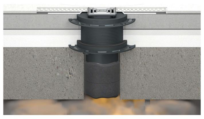
Dallmer Brandschutzelemente sorgen mit Hilfe einer Quellstoff-Einlage dafür, dass Rohre, Entwässerungsleitungen und Bodenabläufe aus Kunststoff im Brandfall sicher verschlossen werden. Die Elemente sind einfach zu installieren, ohne zusätzliches Material. Sie sind für Decken der Feuerschutzklassen F 30/60/90/120 zugelassen und kompatibel zu Dallmer Bodenabläufen und Duschrinnen.
