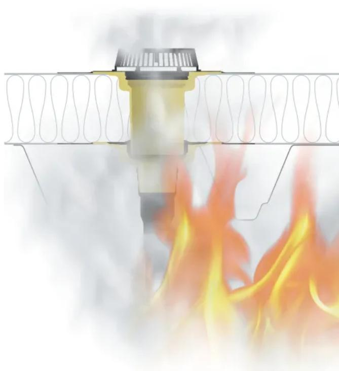
Ohne SitaFireguard® Bei einem nicht geschützten Gully können Anschlussrohr und Gully verbrennen. Flammen können von innen nach außen auf das Dach überspringen.
