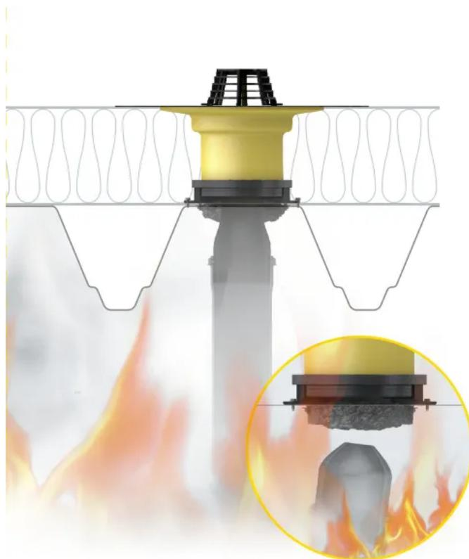
Mit SitaFireguard® Im Brandfall verschließt der SitaFireguard® die Durchdringung im Dach. SitaFireguard® ist für Konstruktionen nach DIN 18234 geeignet.
