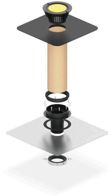
Sita Brandschutzlösungen für Gullys und Lüfter erfüllen den vorbeugenden Brandschutz bei Flachdächern mit Anforderungen nach DIN 18234. Sie verhindern die Brandweiterleitung über Entwässerungs- und Lüftungsbauteile. Im Brandfall verschließt der SitaFireguard die Durchdringung im Dach.
