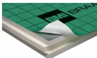
**DivoDämm Top** ist die Lösung für maximale Dämmwirkung bei niedriger Dämmstoffdicke – ein hocheffizientes Dämmelement für den Einsatz im Neubau und in der Dachsanierung. Die Verlegung erfolgt als vollflächige Dämmung oberhalb der Sparren, was Wärmebrücken verhindert und eine Schalung entbehrlich macht.
