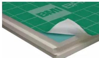
**DivoDämm Kompakt** empfiehlt sich als diffusionsoffenes Dämmelement mit optimalen Werten sowohl bei der Modernisierung als auch im Neubau. Die Verlegung erfolgt als vollflächige Dämmung oberhalb der Sparren, was Wärmebrücken verhindert und eine Schalung entbehrlich macht. DivoDämm Kompakt kann bei entsprechender Stärke auf bestehender Zwischensparrendämmung aufgebracht werden.
