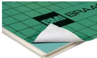
**DivoDämm Pro** ist das ideale Zusatz-Dämmelement für die Kombination von Zwischensparren- und Aufsparrendämmung. Es sorgt für eine energetische Verbesserung und verhindert nach vollflächiger Verlegung oberhalb der Sparren das Entstehen von Wärmebrücken. Bei der Kombination von einer Zwischensparrendämmung mit DivoDämm Pro ist eine Dampfsperre erforderlich.
