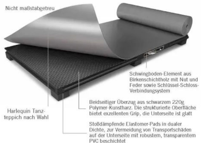
Harlequin Liberty HD Schwingboden mit strukturierter Oberflächenbeschichtung – wetterfest, verschleißbeständig und rutschsicher
