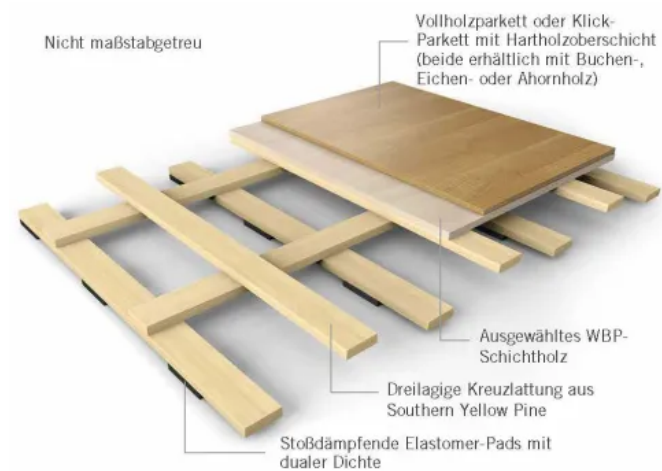
Harlequin WoodSpring Engineered Hardwood Top – mit Mehrschichtparkett – oder Solid Wood Top – mit Massivparkett
