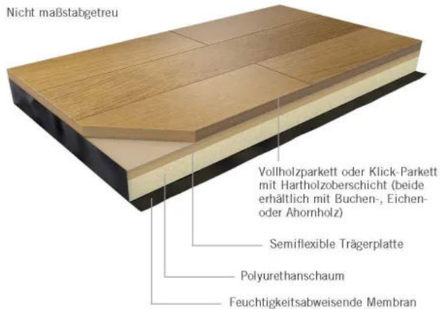
Harlequin Activity Engineered Hardwood Top – mit Mehrschichtparkett – oder Solid Wood Top – mit Massivparkett
