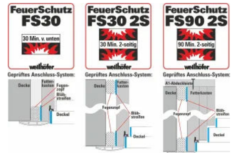
FeuerSchutz für Wellhöfer Bodentreppen für alle Brandschutzanforderungen
