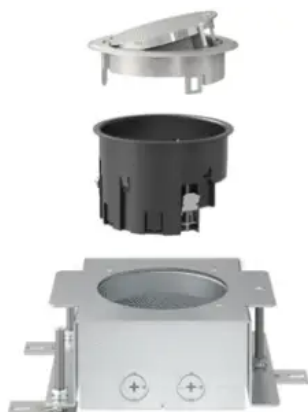
Die GES R2 ist modular aufgebaut aus Geräteinsatz (passend für Modul 45®-Einbaugeräte), Installationsdose und nivellierbarer Estrichdose.
