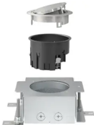
Die GES R2 ist modular aufgebaut aus Geräteeinsatz (passend für Modul 45®-Einbaugeräte), Installationsdose und nivellierbarer Estrichdose.
