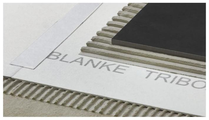
BLANKE TRIBOARD ist eine dünnschichtige Trittschallminderungs- und Entkopplungsplatte mit hoher Druckfestigkeit für Verkehrslasten bis 5 kN/m² zur Aufnahme von Keramik- und Natursteinbelägen. Trotz nur 3 mm Dicke erreicht sie eine geprüfte Trittschallverbesserung von bis zu 17 dB nach DIN EN ISO 140-8. BLANKE TRIBOARD zeichnet sich durch ein geringes Gewicht sowie eine hohe Reißfestigkeit aus und eignet sich als Trägerelement und ist ein sehr emissionsarmes Produkt.
