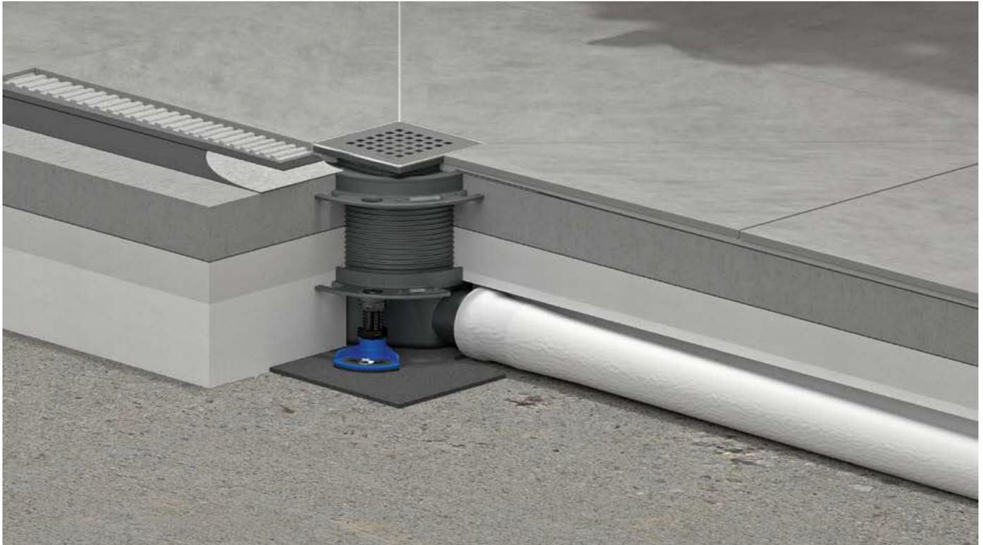
Für die Punktentwässerung von Nassräumen und bodengleichen Duschen bietet Dallmer verschiedene Abläufe aus Kunststoff - als praktische Gesamtpakete oder individuell zusammenstellbare Lösungen: DallDrain-Abläufe sind mit DIN 18534-konformer Dichtmanschette für den Anschluss an die Verbundabdichtung ausgerüstet. Aufsätze, Roste und Anschlussstücke sowie geprüfte Brandschutzlösungen für den Deckeneinbau ergänzen das Programm.
