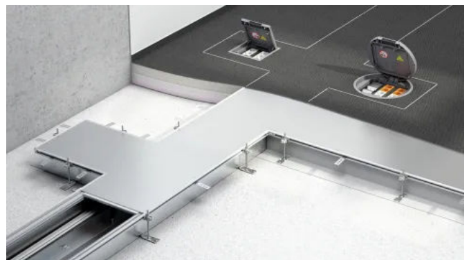
Die estrichbündigen Kanäle des OKA-Systems werden direkt auf dem Rohbeton montiert und auf die Oberkante des Fertigestrichs nivelliert.
