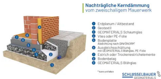
Systemskizze: Nachträgliche Kerndämmung vom zweischaligem Mauerwerk mit GEOMATERIALS Blähglas
