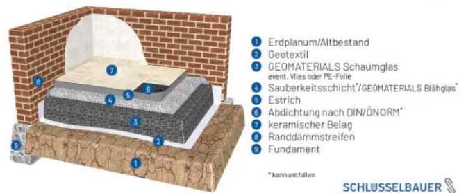
Systemskizze: Fußbodensanierung - Kombination GEOMATERIALS Schaumglas & Blähglas
