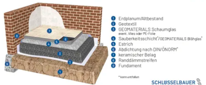
Systemskizze: Fußbodensanierung - Kombination GEOMATERIALS Schaumglas & Blähglas
