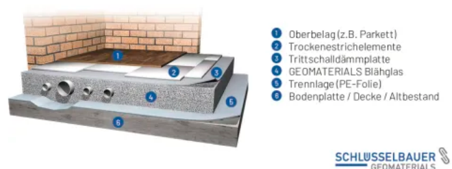
Systemskizze: gebundene Ausgleichsschüttung mit GEOMATERIALS Blähglas
