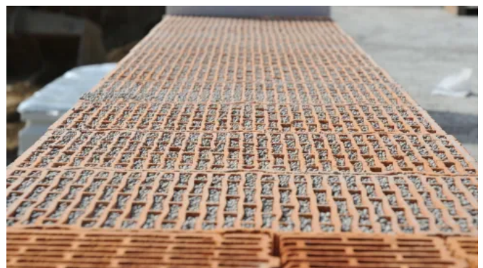
Das Granulat wird in die Hohlkammern des Ziegels eingefüllt
