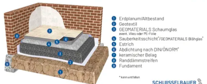
Systemskizze: Fußbodensanierung - Kombination GEOMATERIALS Schaumglas & Blähglas
