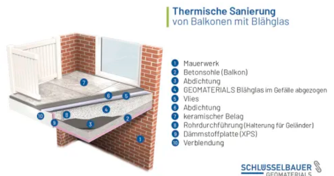
Systemskizze: Thermische Sanierung von Balkonen mit GEOMATERIALS Blähglas
