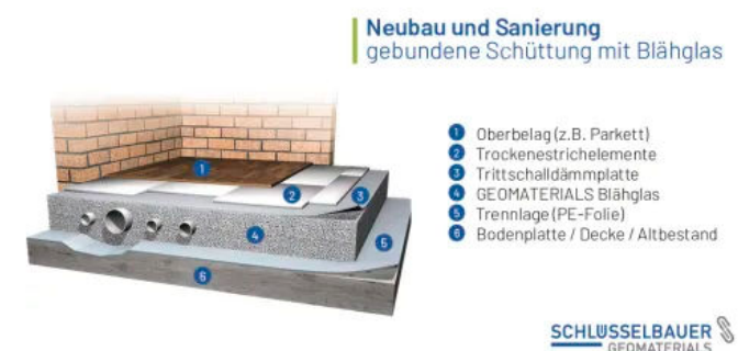
Systemskizze: gebundene Ausgleichsschüttung mit GEOMATERIALS Blähglas
