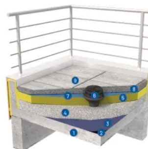
Systemskizze: Gefälledämmung mit GEOMATERIALS Blähglas
