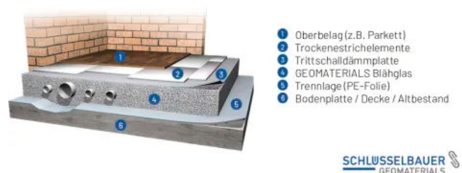
Systemskizze: gebundene Ausgleichsschüttung mit GEOMATERIALS Blähglas
