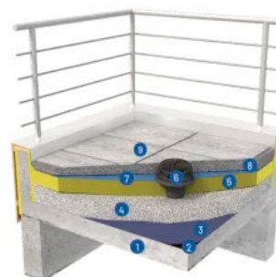
Systemskizze: Gefälledämmung mit GEOMATERIALS Blähglas
