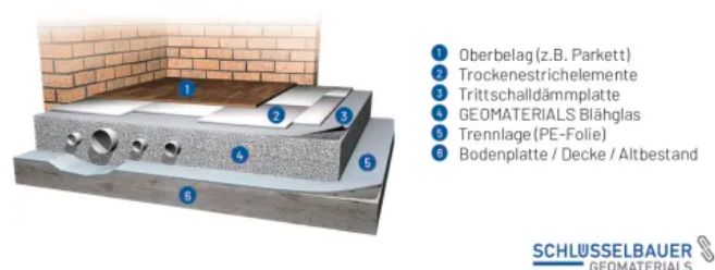
Systemskizze: gebundene Ausgleichsschüttung mit GEOMATERIALS Blähglas
