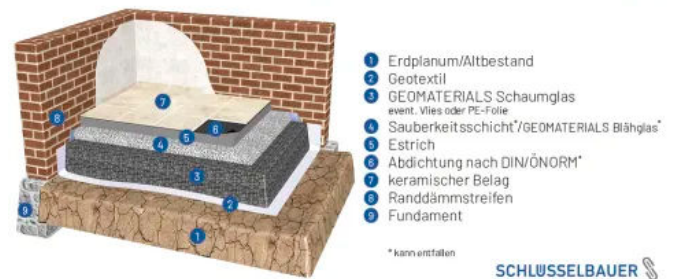
Systemskizze: Fußbodensanierung - Kombination GEOMATERIALS Schaumglas & Blähglas
