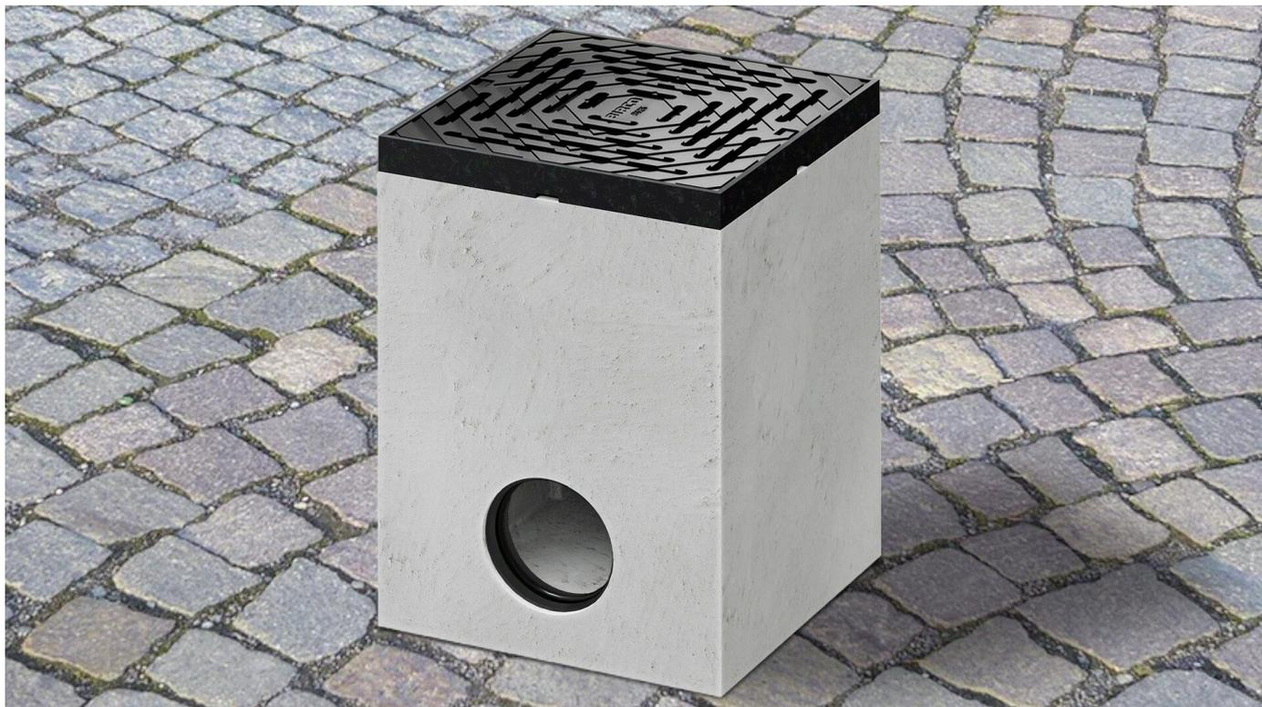
BIRCOLight® ist um eine Punktentwässerung erweitert worden und wird in einem kompletten Setartikel angeboten, mit hochwertigem Gussrahmen mit KTL-Beschichtung und geklemmter Gussabdeckung. Ideal vorbereitet für den Einbau vor Ort mit Geruchsverschluss, Schlammemeier und KG-Muffe. BIRCOLight® Punktentwässerung gehört bei BIRCO in die Rubrik Galabau.
