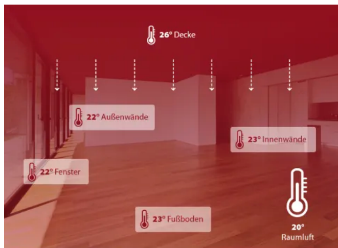
DX-THERM - Deckenheizung im Winter
