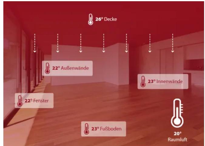
DX-THERM - Deckenheizung im Winter
