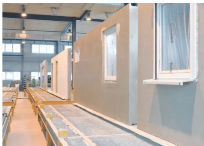
Vorgefertigte Wand - Kalksteinwandtafeln
