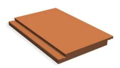
Die Verlegung von Benders Carisma gilt ab 25° Dachneigung (Regeldachneigung) als regensicher. Unter Beachtung des Traglattenabstandes und mit Hilfe von Zusatzmaßnahmen ist die Verlegung dieser Dachsteine bereits ab 10° Dachneigung gestattet.
