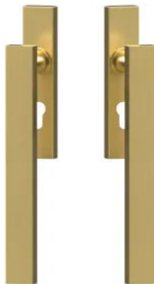
Hebeschiebetürgriff Milano mit rechteckigem Innen- und Außenschild mit PZ-Schloss, in Messing matt | © Karcher Design
