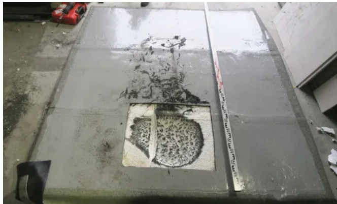
Die Brandschutzbeschichtung REVOPUR® WP220 FP von FRANKEN SYSTEMS hielt den Flammen stand und schützte die darunterliegende, brennbare Dachkonstruktion zuverlässig. Der Brand breitete sich nicht auf der obersten Beschichtung aus. (© FRANKEN SYSTEMS)
